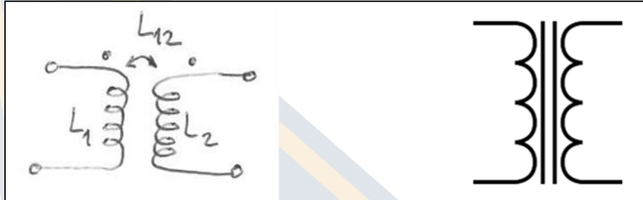
Slika 13 Šematski simbol transformatora
